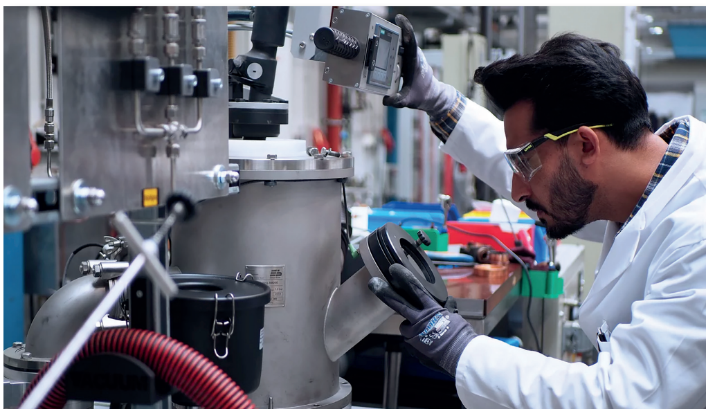
Ubaid Manzoor, doktorant w MPI-SusMat i pierwszy autor publikacji w czasopiśmie „Nature”, przy piecu łukowym, w którym redukuje niskiej jakości rudy niklu za pomocą plazmy wodorowej. (Prawa autorskie: Max-Planck-Institut für Nachhaltige Materialien GmbH)
